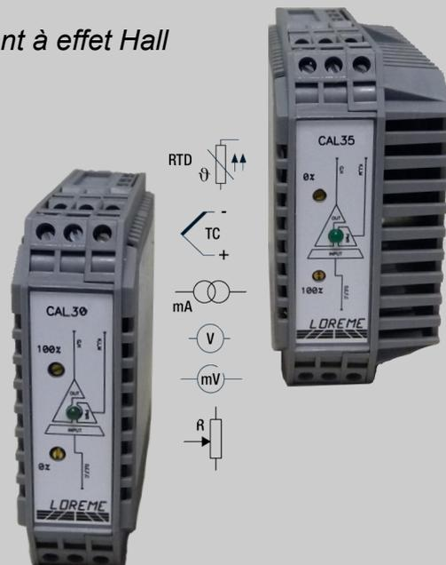
Les convertisseurs de mesure CAL30 et CAL35 permettent de transformer, d'adapter et d'isoler une très large diversité de signaux analogique. une conception interne modulaire ( carte d'entrée interchangeable) permet de créer de nouvelles fonctionnalités pour de chaque besoin spécifique.
